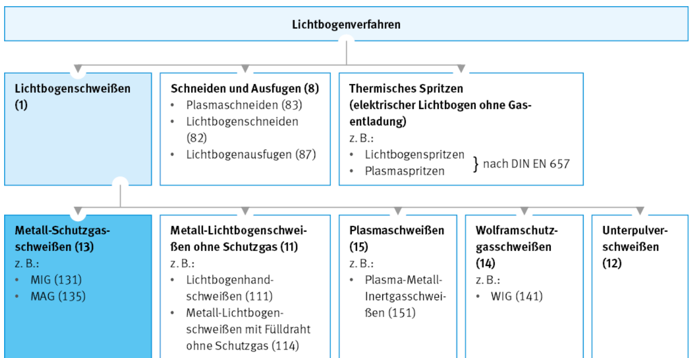
Abb. 1 Lichtbogenverfahren (mit Ordnungsnummern nach DIN EN ISO 4063)
